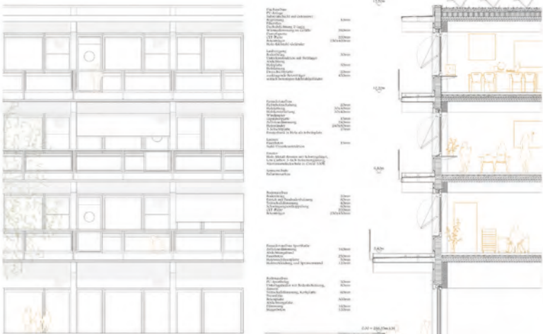
Schnitt durch Erweiterung Schulhaus 1:200
