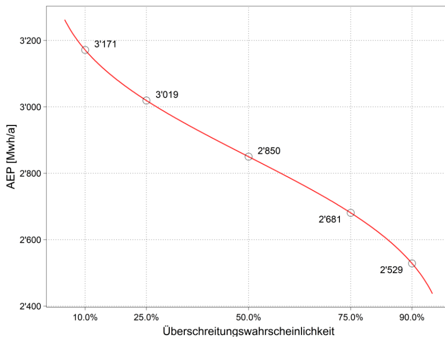
Abbildung 18: Totaler Energieertrag als Funktion der Überschreitungswahrscheinlichkeit für eine WEA des Typs Vestas V110, 2.0 MW mit 125 m Nabenhöhe.
