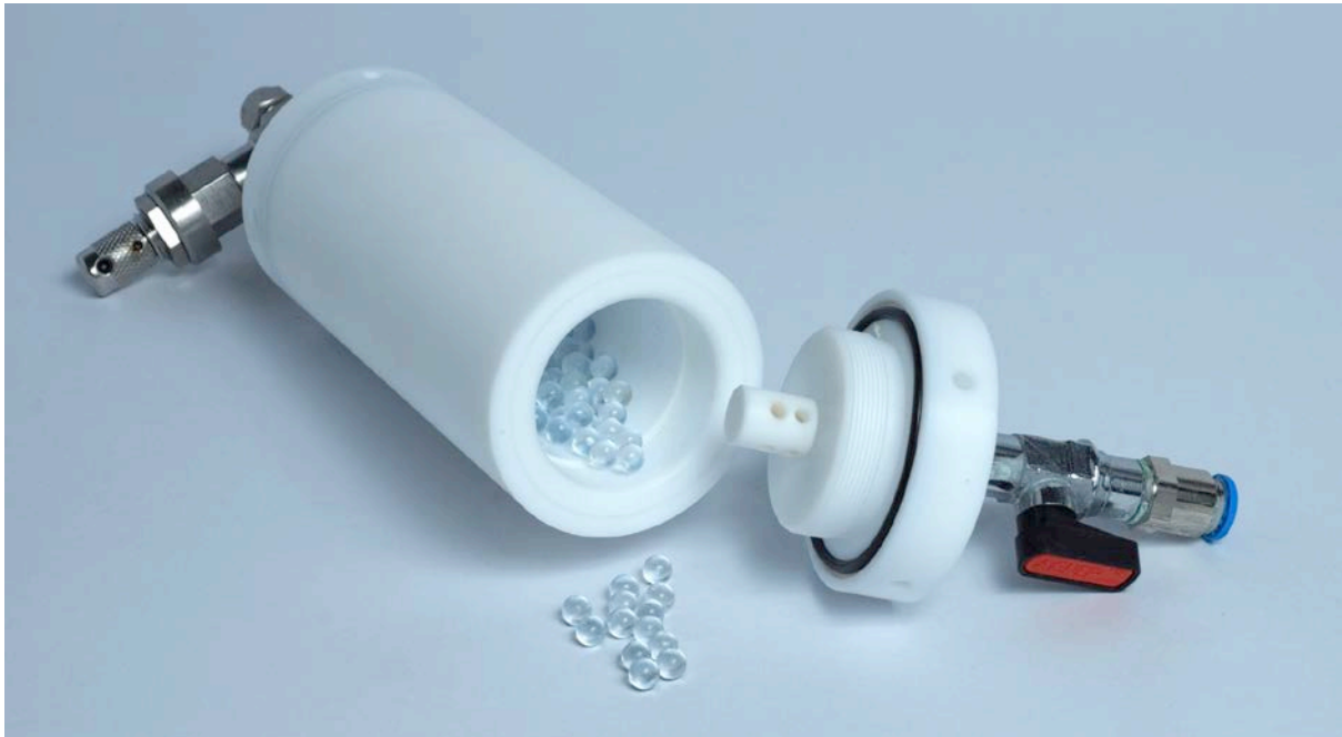
Abb. 3.1: Aufnahme einer Biofilmfalle mit Glaskugeln, Schraubverschlüssen (inklusive Dichtungsringen) und regulierbaren Ventilen.
